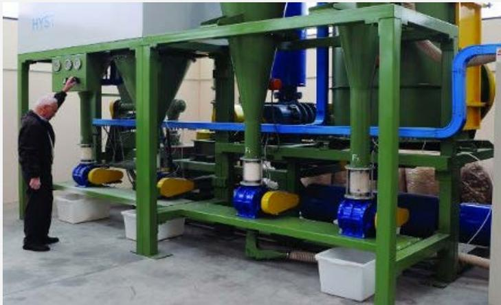
I dispositivi Hyst, che per funzionare utilizzano solo aria ed energia elettrica, sono di piccole dimensioni e si prestano quindi ad essere impiegati in diverse industrie senza troppe difficoltà di trasporto e installazione. Da qui il progetto di installarne in maniera capillare sul territorio africano, per sfruttarne al meglio le potenzialità delle risorse agricole.
